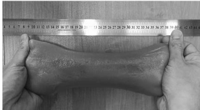
ALPNA-JAM – блокирующий состав для глушения нефтяных, газовых и газоконденсатных скважин в условиях АПНД и АВПД с высоким показателем газового фактора.
